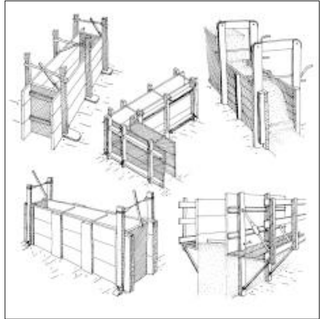
6-3 Encofrados para tapial (Minke 2001)
