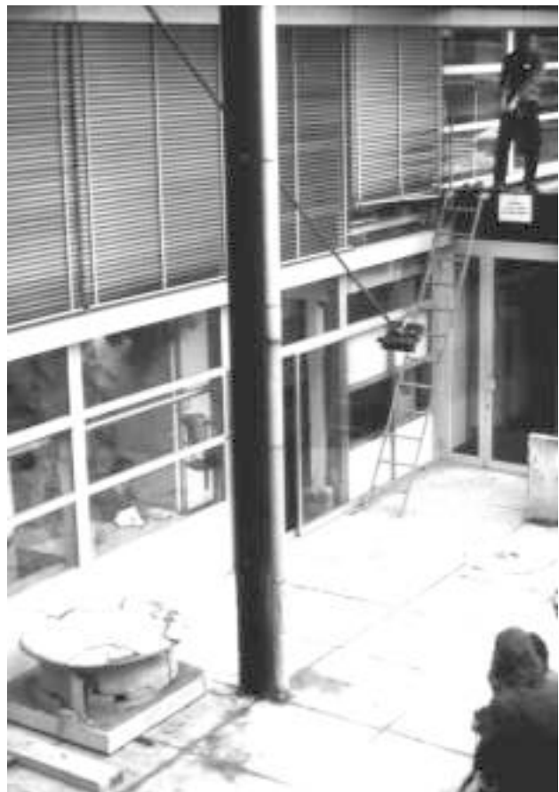
3-3 Simulacro de un impacto sísmico (Minke 2001)
