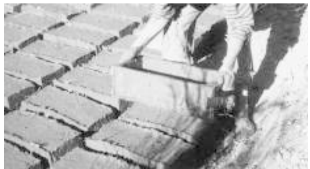
7-2 Proceso de elaboración de adobes en Ecuador
